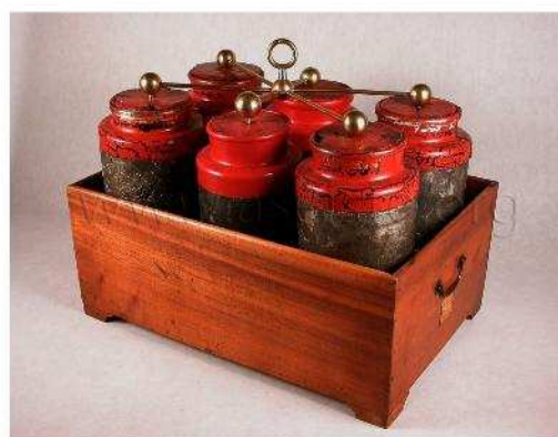
FIGURA 11: À esquerda: Fonte de Heron, Lycée Guez de Balzac, Angoulême. À direita: Bateria de garrafas de Leyden. Lycée Bertran de Born, Périgueux. Fabricantes desconhecidos.
