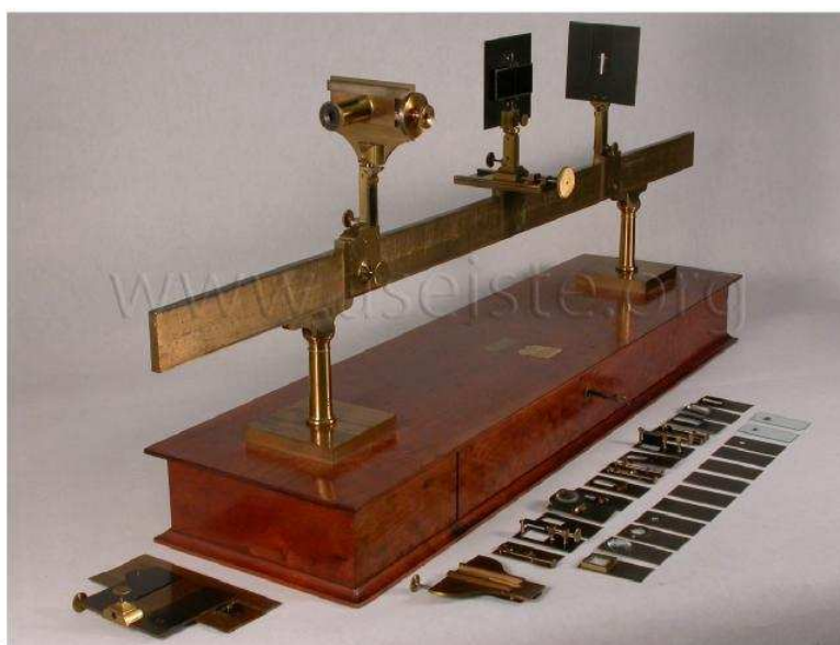
FIGURA 9: Banco de Pouillet, para estudo da interferência e difração. Lycée Bertran de Born, Périgueux. Fabricante: Soleil.
