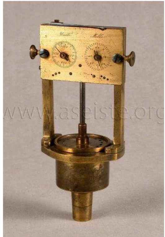
FIGURA 14: Sirène de Cagniard-Latour. Lycée Bertran de Born, Périgueux. Fabricante desconhecido.
