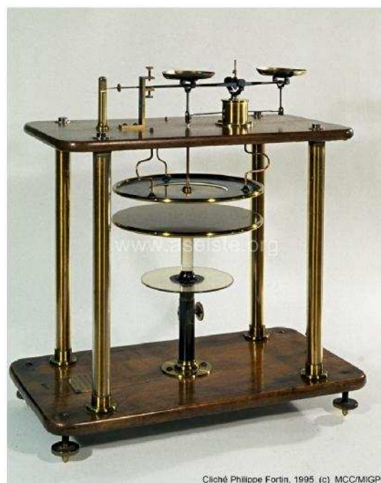
FIGURA 17: Eletrómetro-balança de Abraham-Lemoine. Lycée Chaptal, Paris. Fabricante desconhecido.
