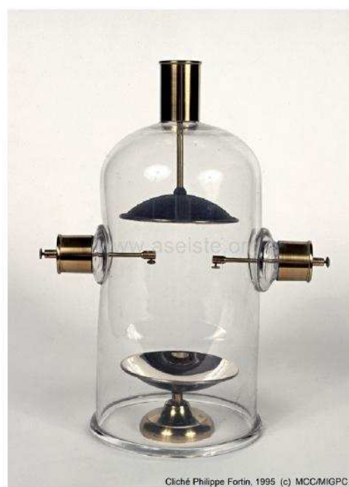
FIGURA 13: Aparelho de Davy, para estudar a “reflexão do calor”. Lycée Chaptal, Paris. Fabricante desconhecido.
