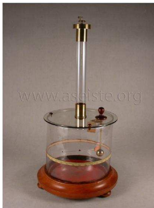
FIGURA 16: Balança eletrostática de Coulomb. Lycée Bertran de Born, Périgueux. Fabricante: Pixii.
