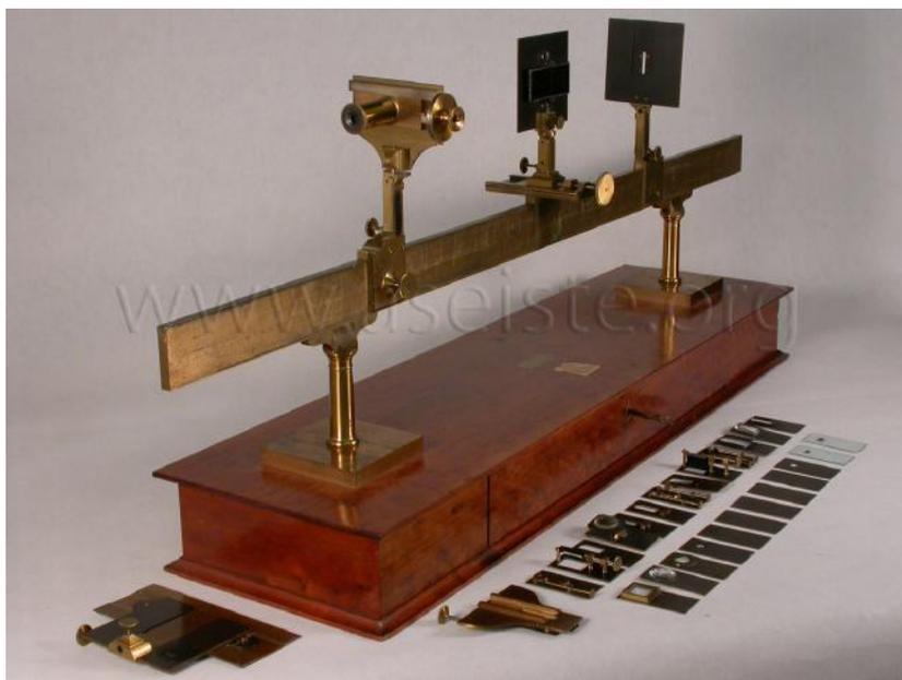
FIGURE 9 – Banc d'interférences et diffraction de Pouillet. *Lycée Bertran de Born, Périgueux*. Constructeur : Soleil.
