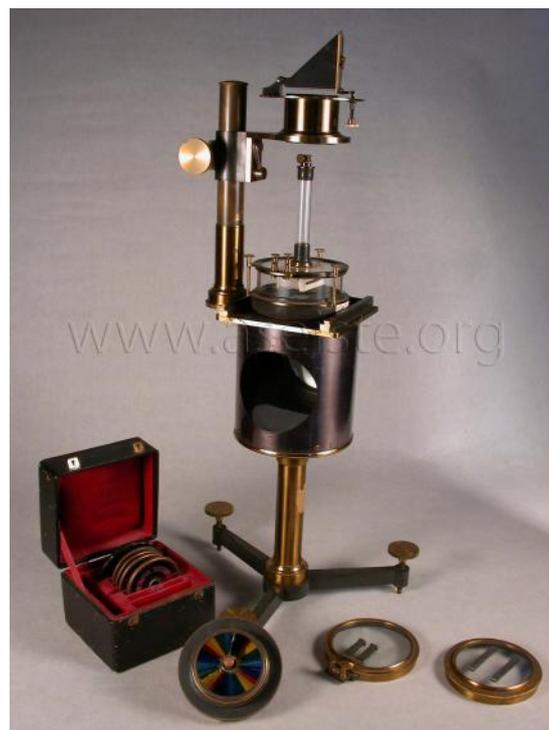
FIGURE 8 – Appareil pour projection verticale. *Lycée Guez de Balzac, Angoulême*. Parmi d'autres utilisations, l'instrument permet de projeter la déviation d'un galvanomètre de Nobili ou un disque de Newton en rotation. Constructeur : Duboscq.
