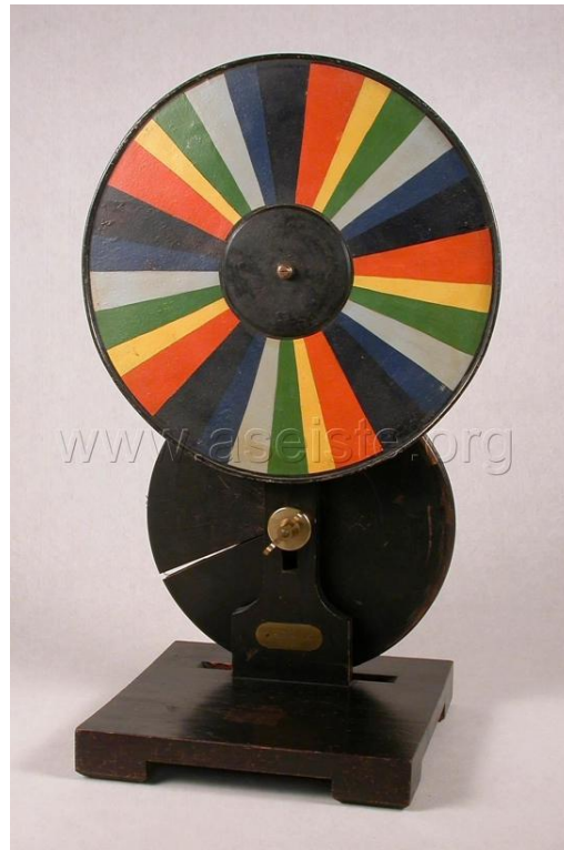
Figura 7: Disco de Newton. Instituto Bertrand de Born , Périgueux. Constructor: Soleil . Altura: 62 cm. El disco funciona con la ayuda de una manivela desmultiplicada (escondida).
