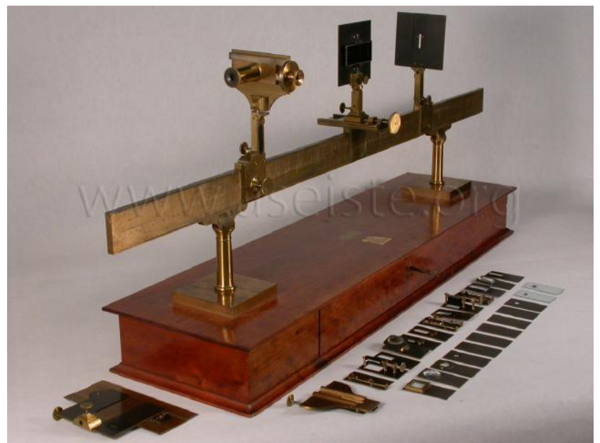
Figura 9: Banco de interferencia y difracción de Pouillet. Instituto Bertran de Born, Périgueux . Constructor: Soleil.
