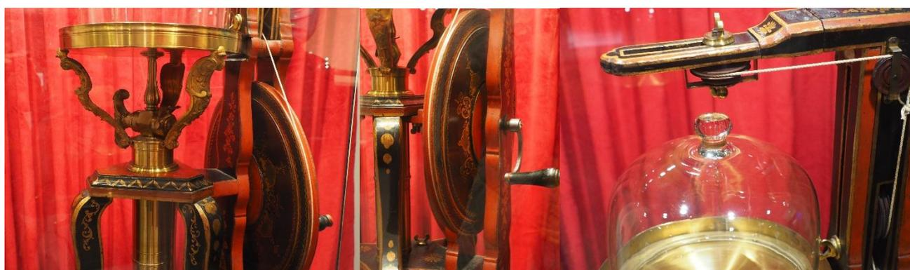
Machine pneumatique à un corps de pompe à rouet
